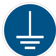
Zemine Topraklama Terminali Bağlayın
